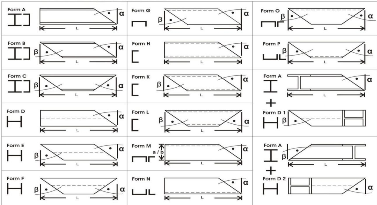
Bei ungleichschenkligen Winkeln (Form M-P) muss wie im Beispiel Form M der sichtbare Schenkel (a / b) bemaßt werden. Langer Schenkel= a, kurzer Schenkel= b.
